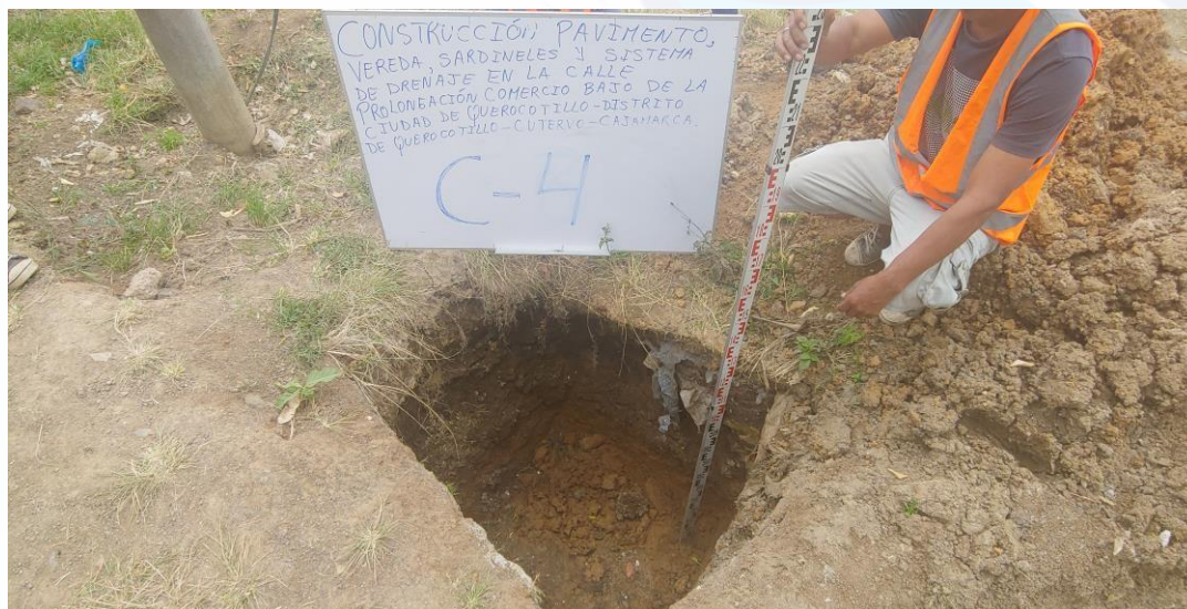
FOTO N° 14: VISTA A CIELO ABIERTO DE LA CALICATA.
