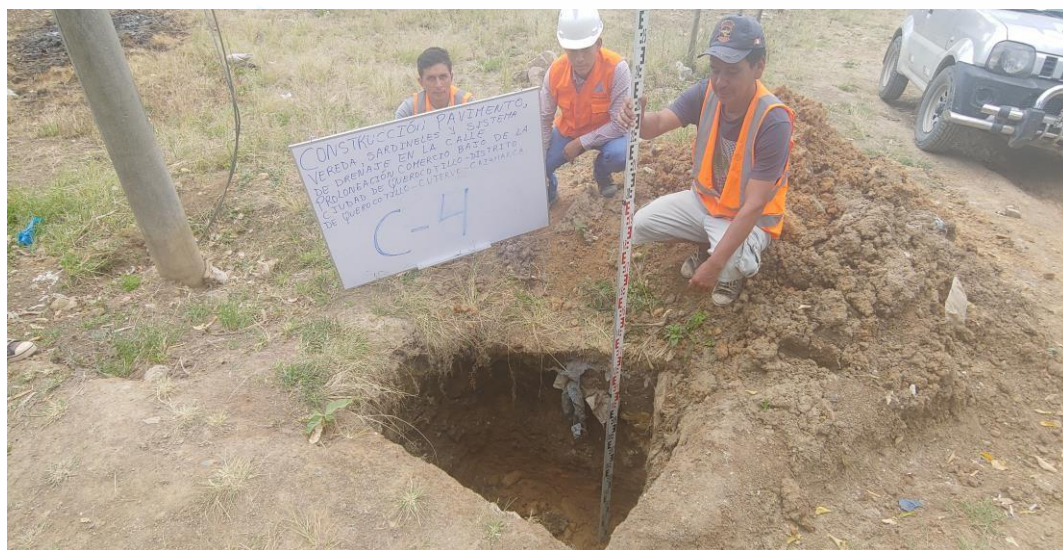
FOTO N° 13: VISTA A CIELO ABIERTO DE LA CALICATA NUMERO 04.
