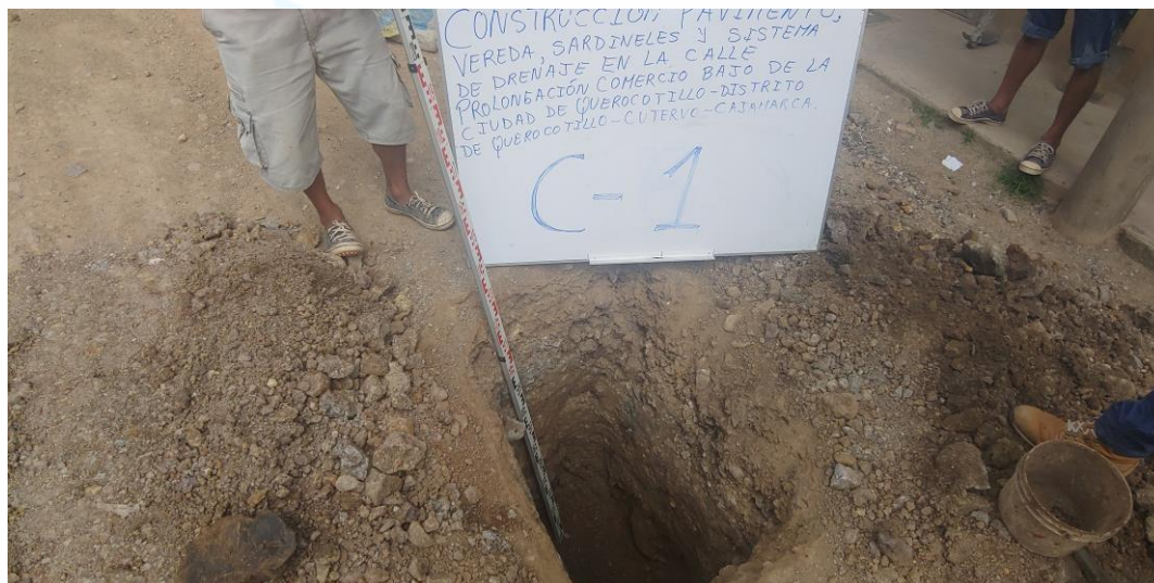
FOTO N° 05: VISTA A CIELO ABIERTO DE LA CALICATA.
