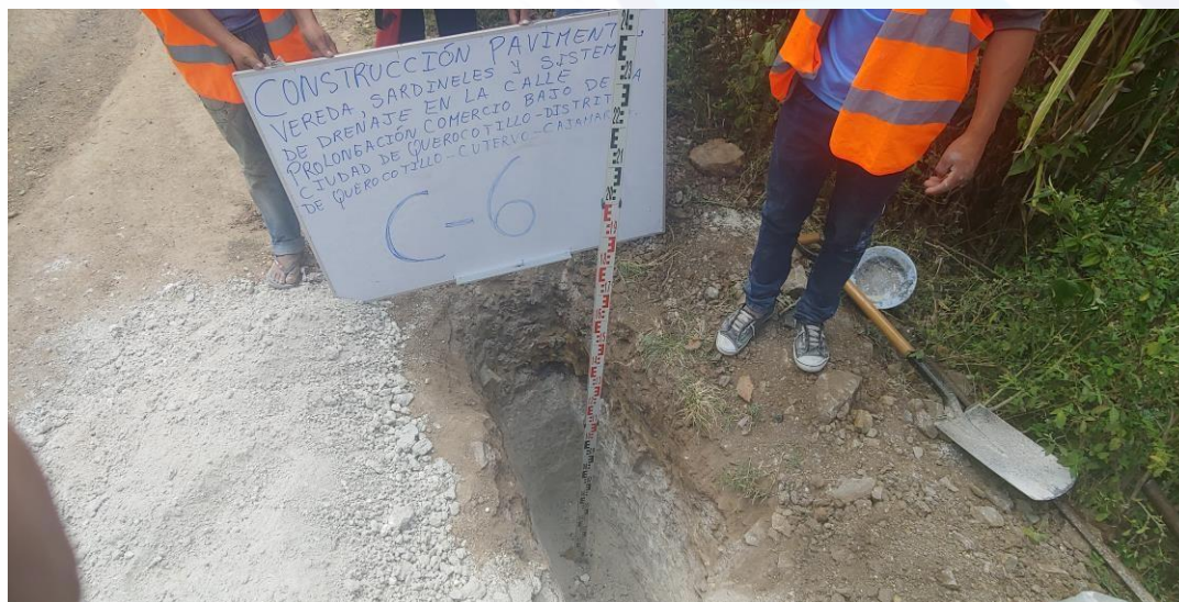
FOTO N° 20: VISTA A CIELO ABIERTO DE LA CALICATA.
