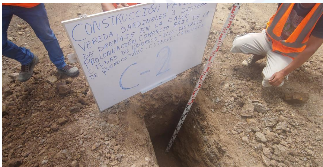
FOTO N° 08: VISTA A CIELO ABIERTO DE LA CALICATA.
