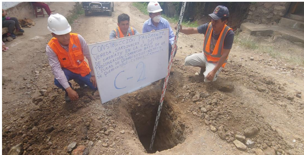
FOTO N° 07: VISTA A CIELO ABIERTO DE LA CALICATA NUMERO 02.
